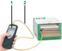
Cấu hình biến tần với Multi-loader VW3A8121 + cáp kết nối VW3A8126
